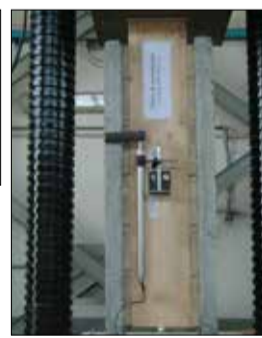
Provino per la prova di resistenza allo scorrimento della connessione LPR.
