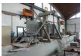
Prova su solaio misto legno-calcestruzzo posato di taglio per verificare la rigidità nel piano, indispensabile per trasmettere ai muri portanti la forza sismica.
