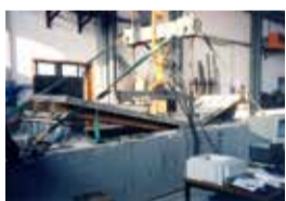
Prova a rottura su solai legno-calcestruzzo con connettori LPR. Un dato rilevante che dimostra la bontà della tecnologia Peter Cox è il comportamento infinitamente rigido della sezione mista anche per macro deformazioni.
